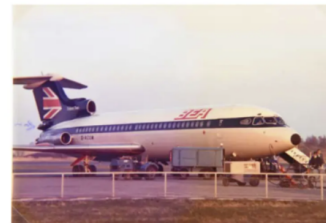
Denna H.S. Trident Two från BEA var ovanlig på så sätt att den hade tre huvudmotorer, en startjetmotor och en APU, Auxiliary Power Unit. Dessutom satt nosstället inte i centrum.
