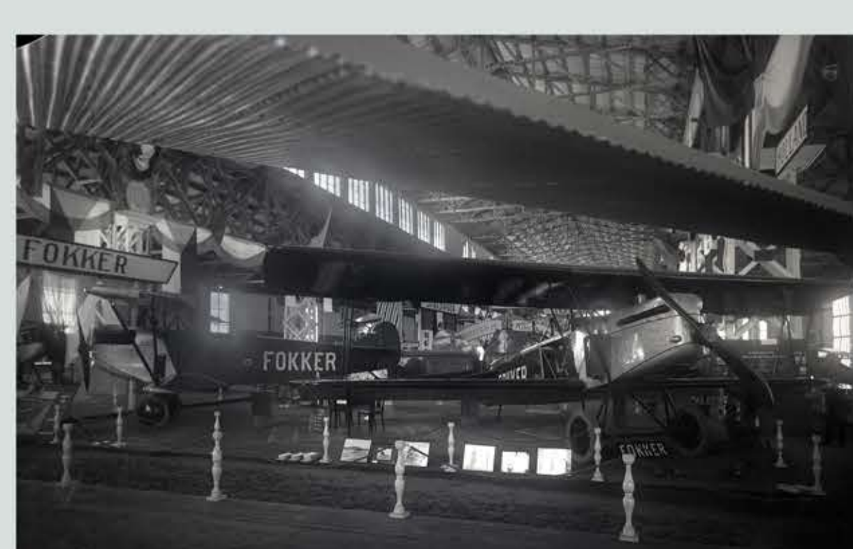
I monter nr.83 visade Nederlandsche Vliegtuigenfabriek (Fokker) två militärflygplan: till vänster Fokker D.XI, utrustad med en 300 hk Hispano-Suiza 8Fb V-8 kolvmotor och till höger Fokker C.IV, där en panel har tagits bort från flygkroppen.
