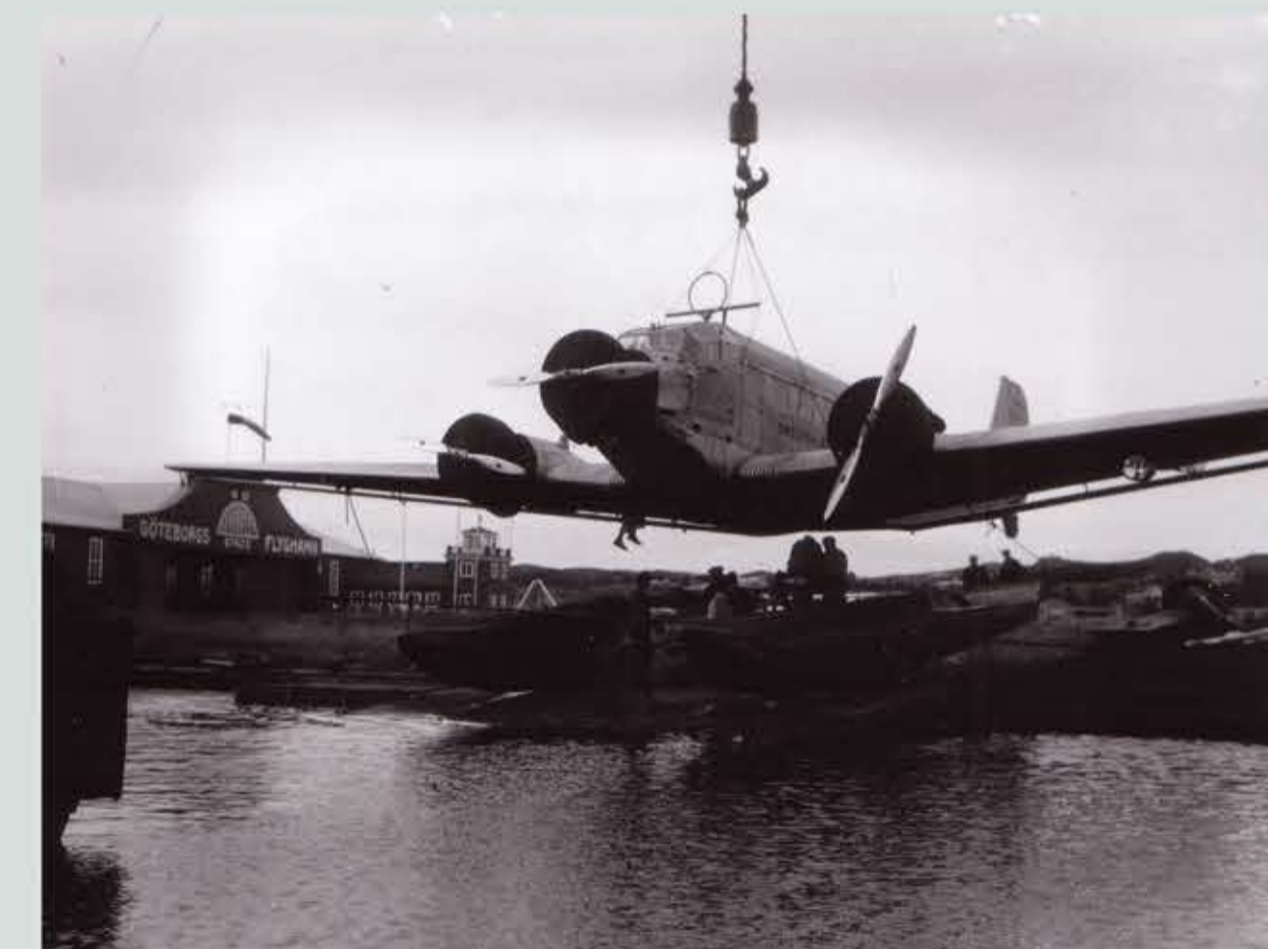
ABAs Junkers Ju-52 Södermanland byter från hjul till flottörer eller tvärtom, vid slipen.
