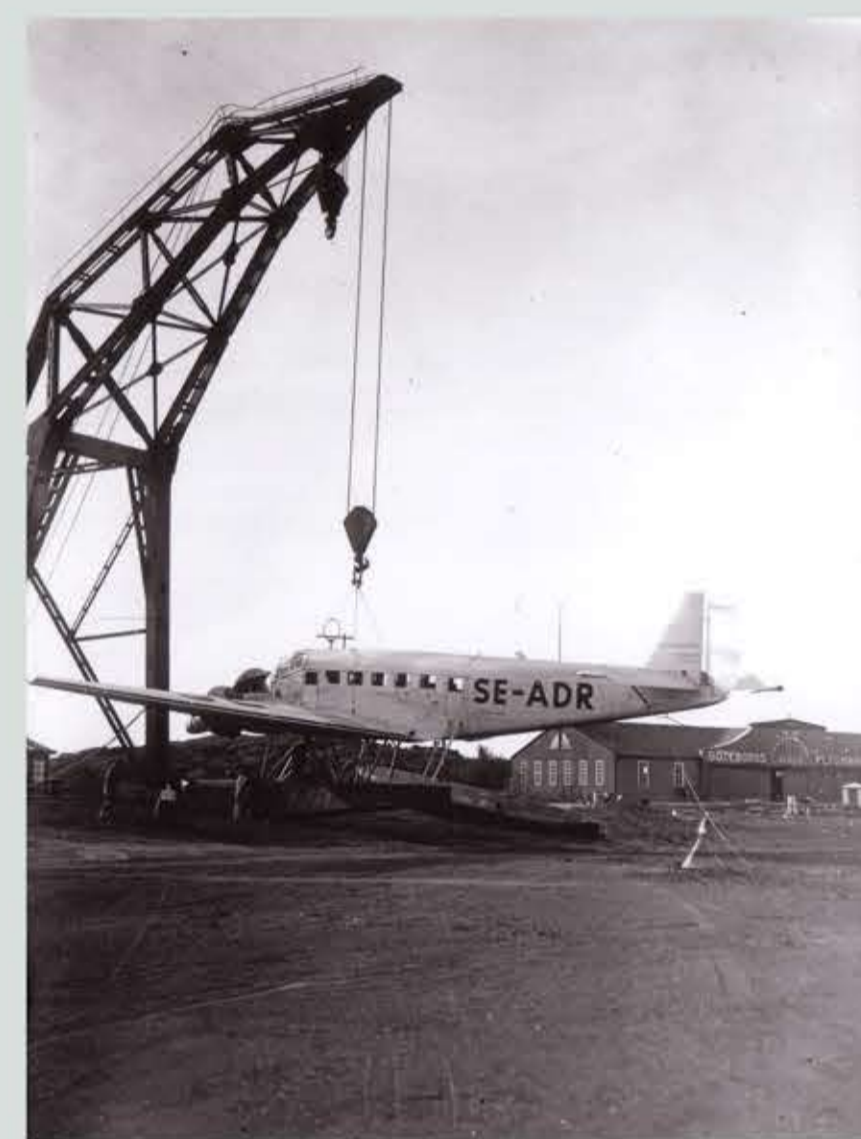
ABAs Junkers Ju-52 Södermanland byter från hjul till flottörer eller tvärtom vid slipen.
